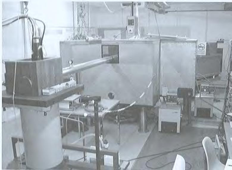
Fig.2 : Vue d'ensemble du spectromètre à cristal DuMond. Au premier plan on distingue la chambre à cible surmontée d'un tube de rayons X (100 kV, 3 kW) pour la production de la fluorescence des échantillons, au second plan l'enceinte thermostatisée renfermant le cristal et son entraînement ainsi que l'interféromètre Doppler et à l'arrière plan le système collimateur-détecteur.
