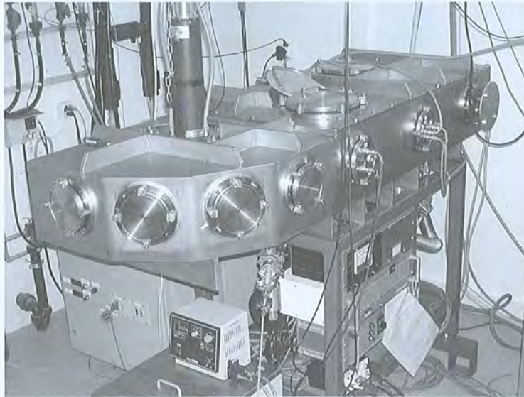
Fig. 3 : Spectromètre von Hamos avec son système de pompage. Les quatre fenêtres circulaires visibles sur l'avant servent à connecter l'instrument à la ligne de faisceau de l'accélérateur sous différents angles.
